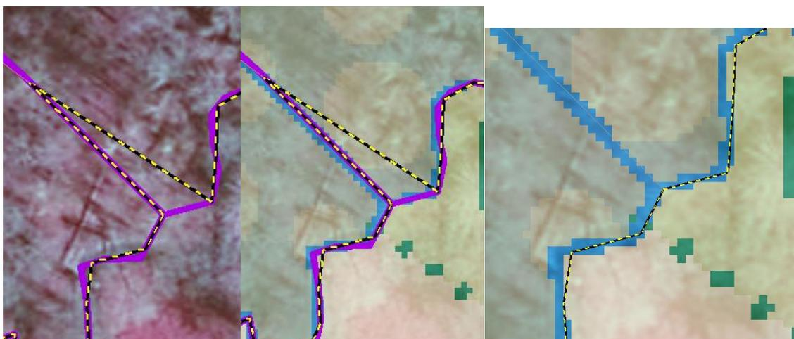
Figure 3 - Géométrie vectorielle : Artefact et correction manuelle du problème.
