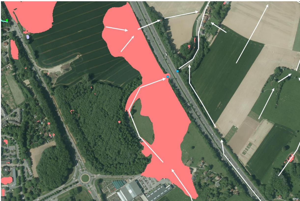
Figure 2 : La dépression principale en rose identifiée par la fonction « Sinks » de Whitebox GAT résulte de la présence de l'autoroute en surplomb qui crée artificiellement une accumulation d'eau. Les points bleus renseignent en effet un passage souterrain qui permet les écoulements tels que constatés par les experts de terrain GISER (flèches blanches). Figure extraite du rapport final de la première convention LIDAXES.
