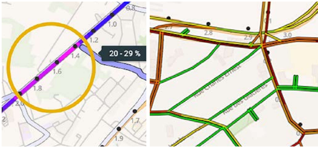
Q FCD : analyse de la répartition des flux et des vitesses pratiquées. Source : flowcheck.be-mobile.biz
